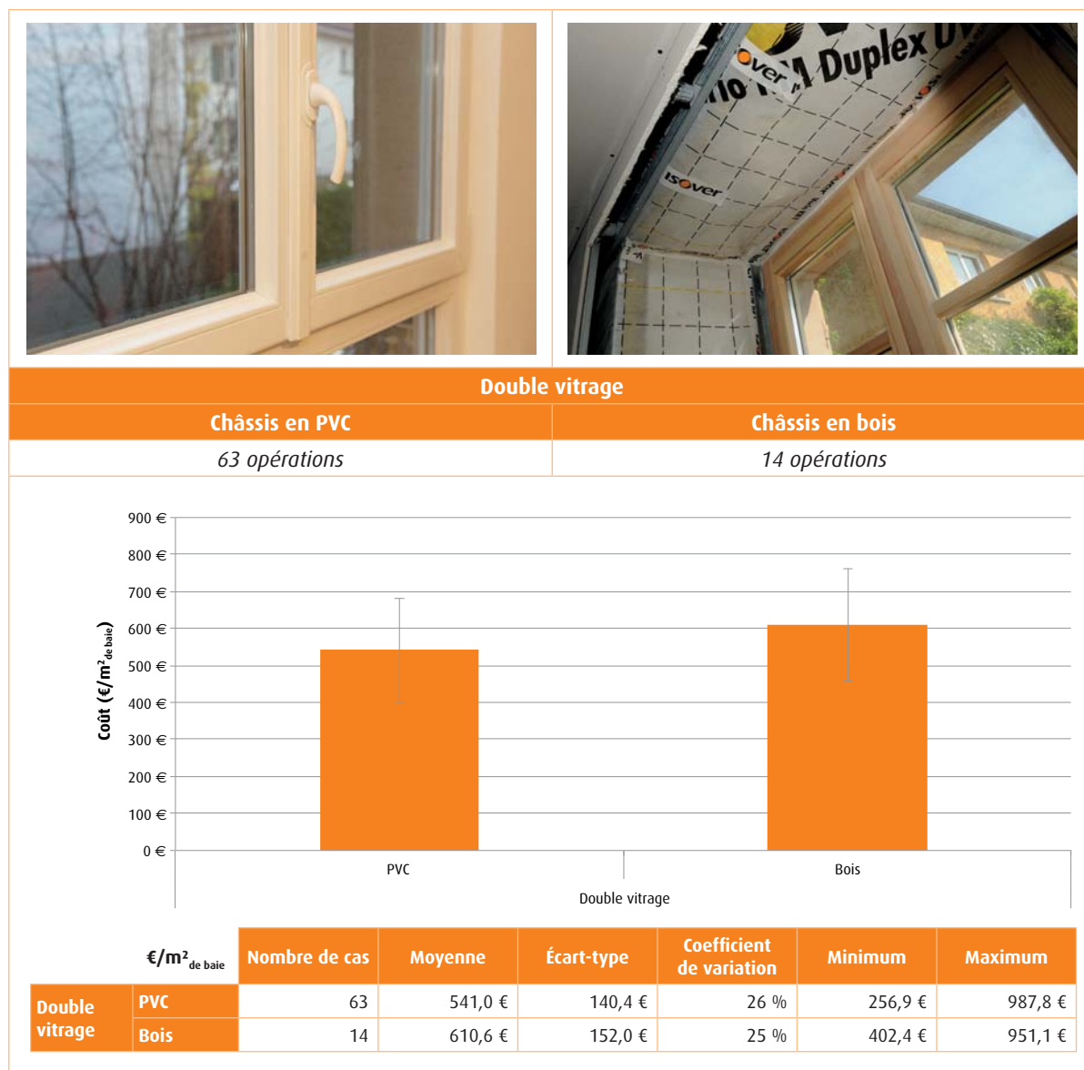
Figure 11 : Coûts de renouvellement des menuiseries selon les produits utilisés.
